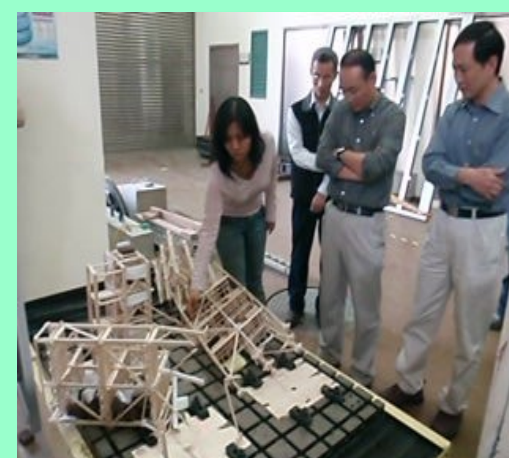
模型測試後討論破壞情形
