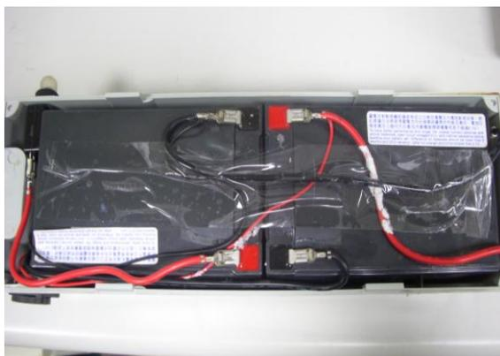
電動自行車鉛酸電池
