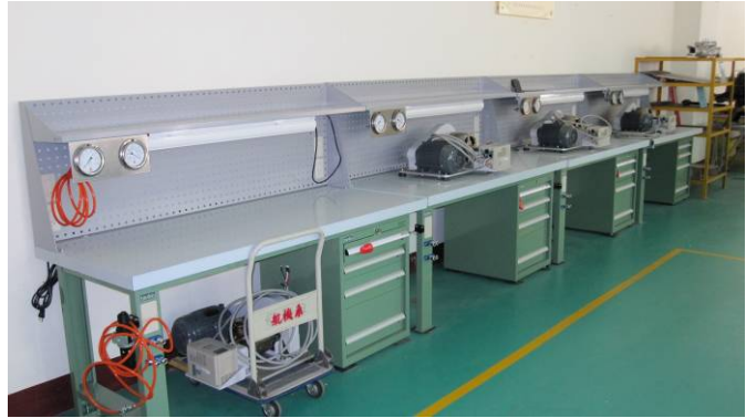
圖 4、複合材料修補工作台
