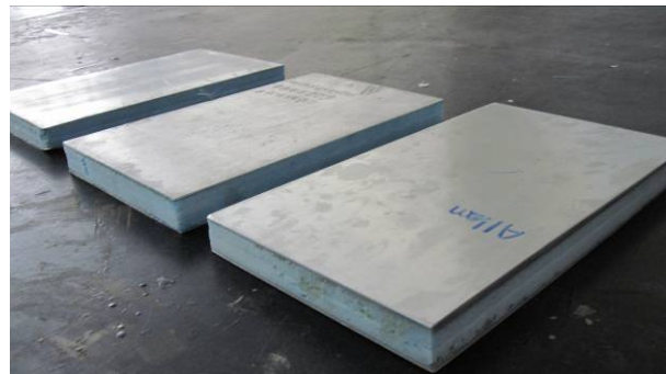
圖 22、複合材料三明治試片
