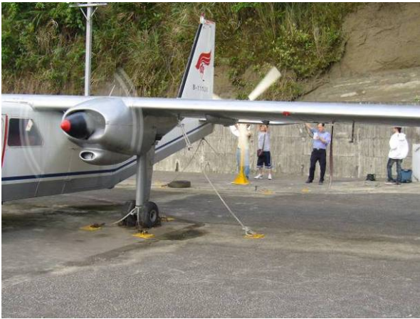
圖 11、飛機人工風場測試風力發電性能
