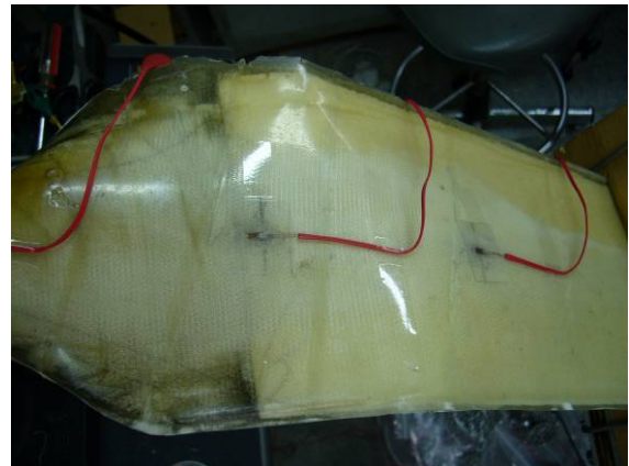
圖 18 1.5kw 風力機彎曲強度試驗
