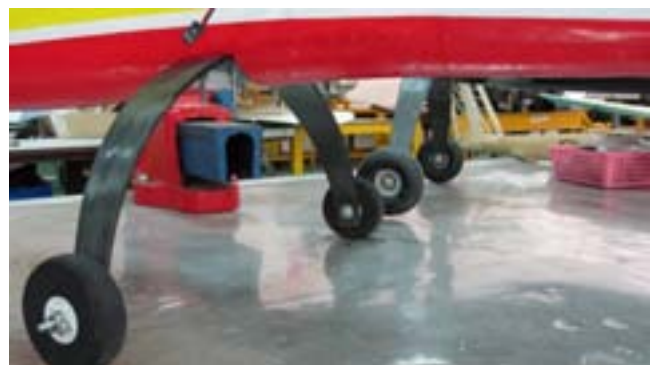
圖 14. 自行製作之碳纖維飛機起落架
