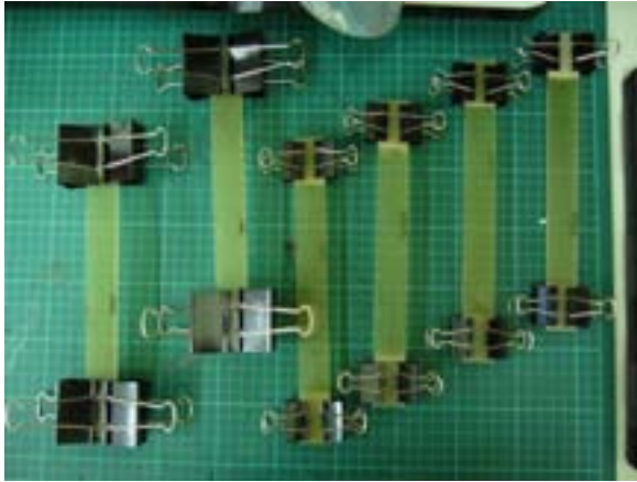
圖 41、複合材料不同疊層及角度試片製作 圖 42、複合材料試片安裝應變規
