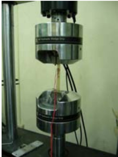
圖 43、複合應力/應變實驗 圖 44. 新購材料拉伸實驗機
