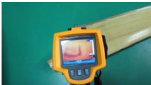
圖 48. 紅外熱像儀探傷
