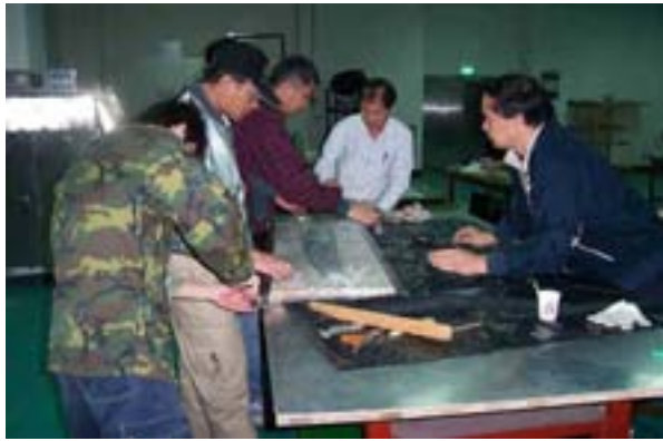
圖 18. 複合材料翼肋 I 型樑製作
