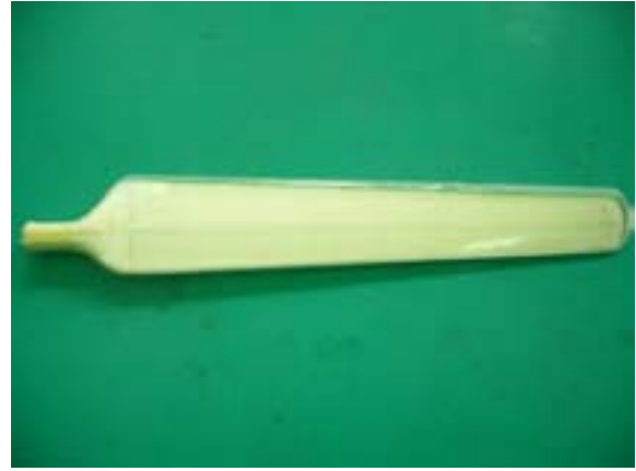
圖 40、複合材料風車葉片成型
