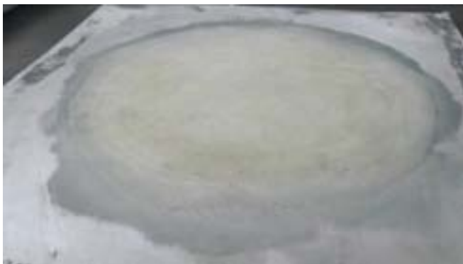
圖 9. 複合材料修補金屬片
