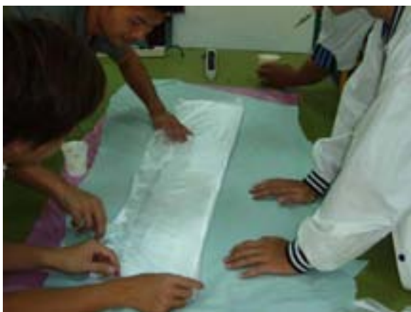
圖 13. 遙控複合材料飛機機翼製作
