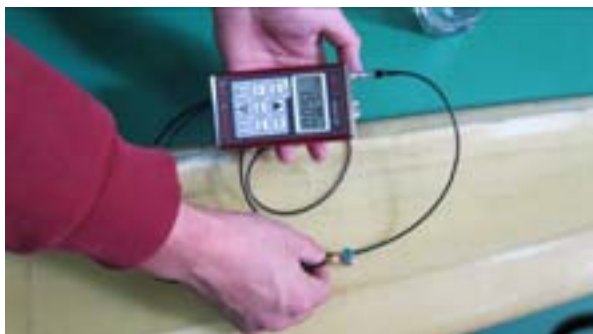
圖 47. 超音波非破壞性檢測
