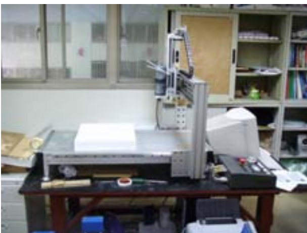
圖 19、複合材料葉片 CNC 芯模製作
