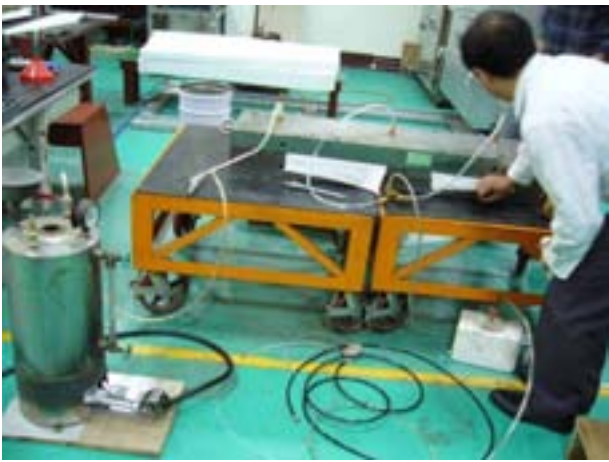
圖 21、複合材料樹脂轉注法
