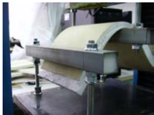
圖7、複合材料三明治結構彎曲實驗
