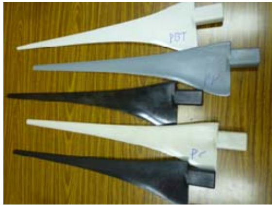
圖 25、複合材料熱塑型射出模具組合 圖 26、複合材料熱塑型射出葉片
