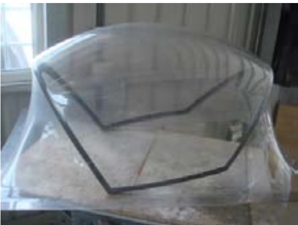
圖 11、複合材料超輕飛機機翼製程
