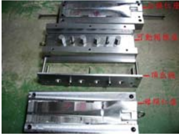
圖 25、複合材料熱塑型射出模具組合 圖 26、複合材料熱塑型射出葉片
