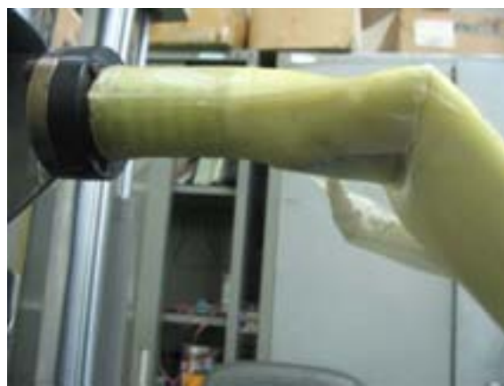
圖 27、風力葉片負載破壞實驗
