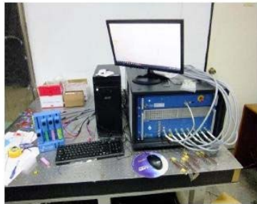
模組式電池充放電設備
