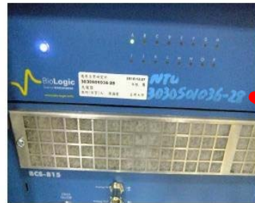
模組式電池充放電設備-財產貼牌
